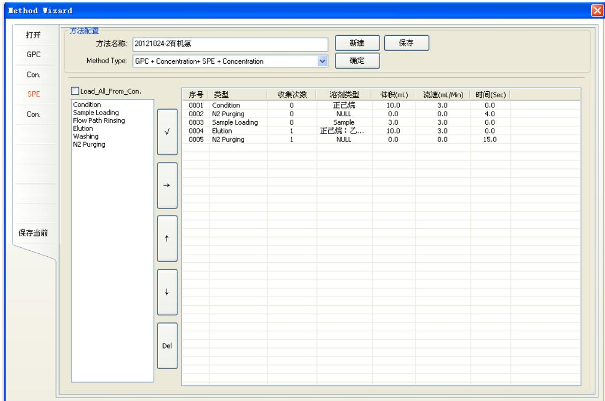
图3. SPE净化 (NH<sub>2</sub>/Carb固相萃取柱活化、上样、洗脱、氮气吹干)
